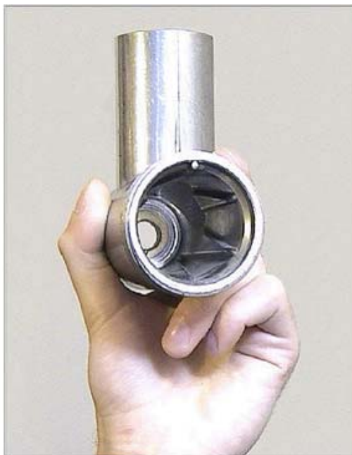
Насадка от электромясорубки производства ЛЭЗ ЛПЭО «Электросила» с клиновидными ребрами на корпусе
