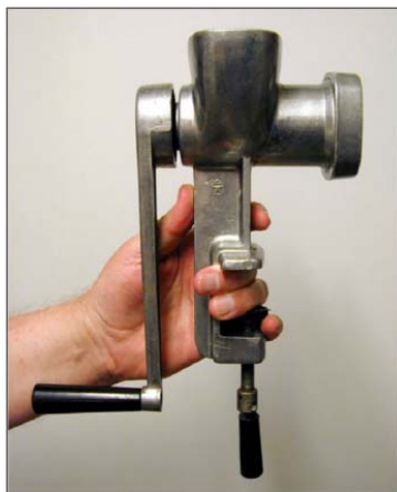
Ручная мясорубка производства объединения «Кировский завод» с прямолинейными ребрами на корпусе
