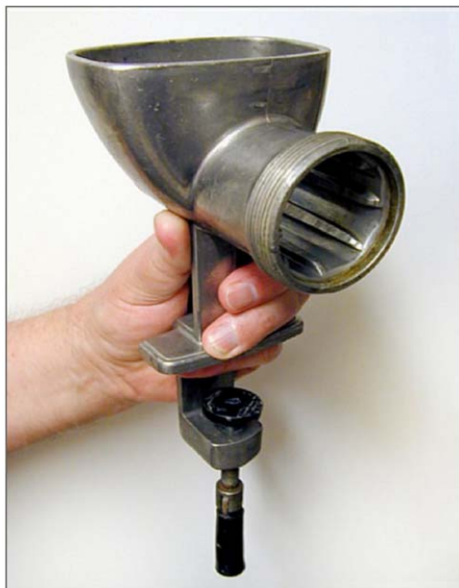
Ручная мясорубка производства объединения «Кировский завод» с прямолинейными ребрами на корпусе
