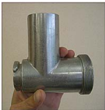
Насадка от электромясорубки производства ЛЭЗ ЛПЭО «Электросила» с клиновидными ребрами на корпусе
