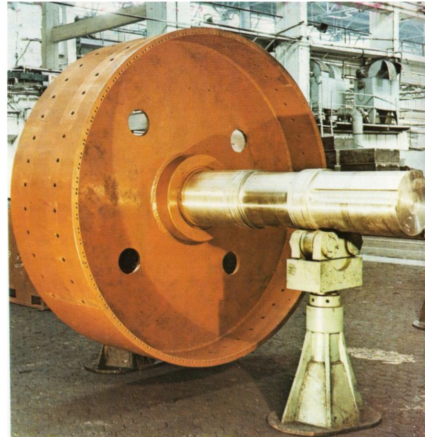
Остов ротора тихоходного двигателя Rotor Body of Slow-Speed Motor
